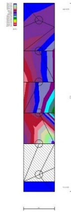
Fig. 13 - Piastra fondazione - Taglio Tx (Combinazione n° 2)
