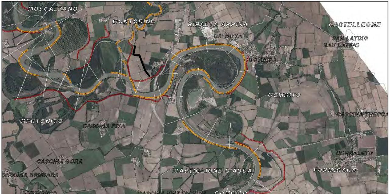
Figura 3 – Disposizione rilevati arginali e difese spondali esistenti. Planimetria d'insieme (in nero il rilevato arginale di recente realizzazione)
