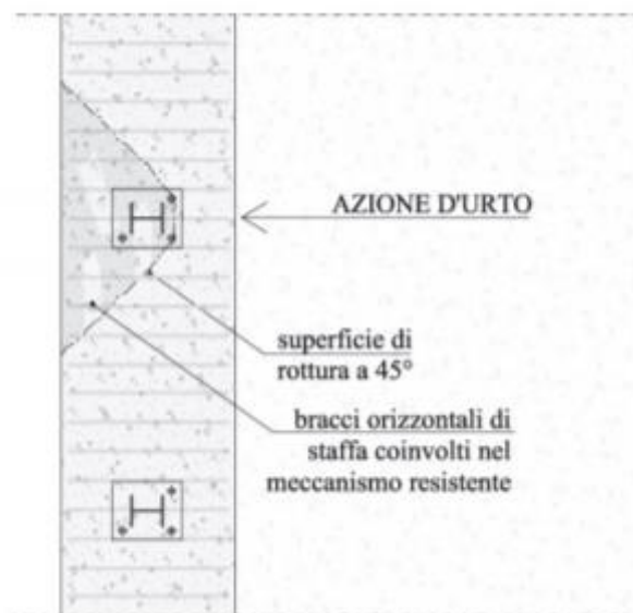
Figura 29 – cono di diffusione verifica staffe orizzontali
