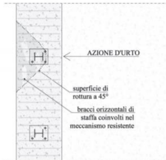
Figura 40 – cono di diffusione verifica staffe orizzontali
