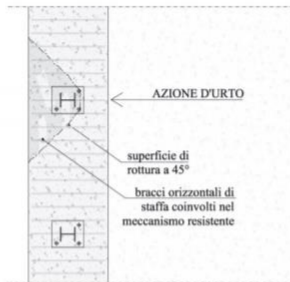
Figura 42 – cono di diffusione verifica staffe orizzontali
