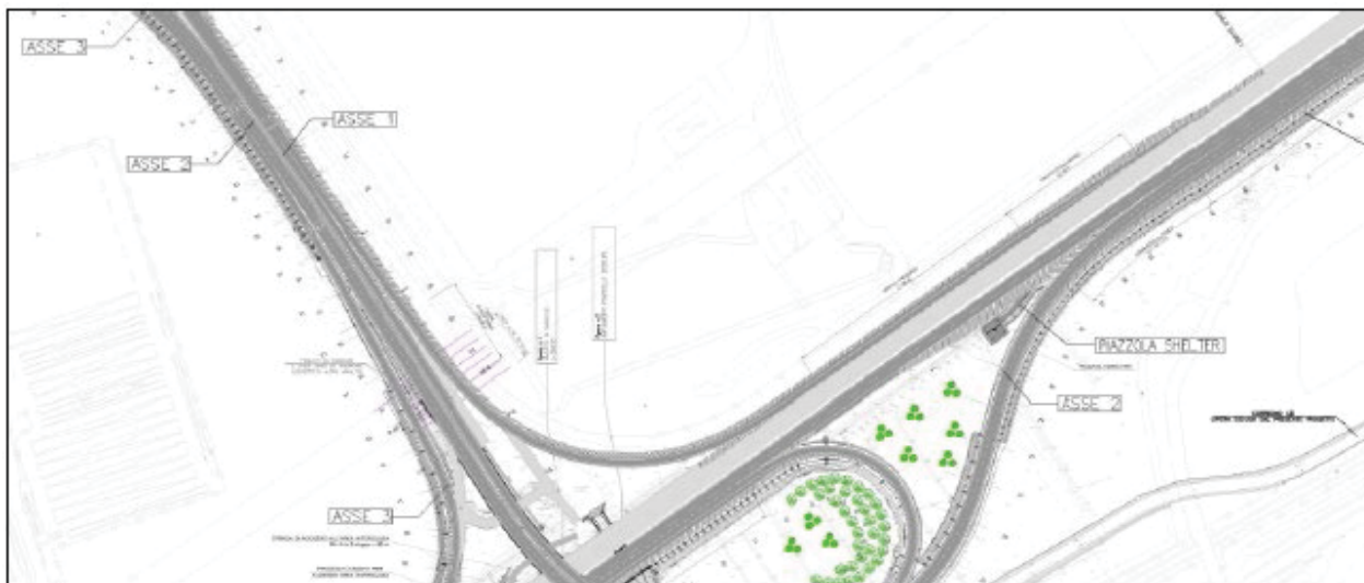
Figura 3-1: Planimetria di Progetto – Dettaglio riduzione ad una corsia della rampa Roma – Cargo City
