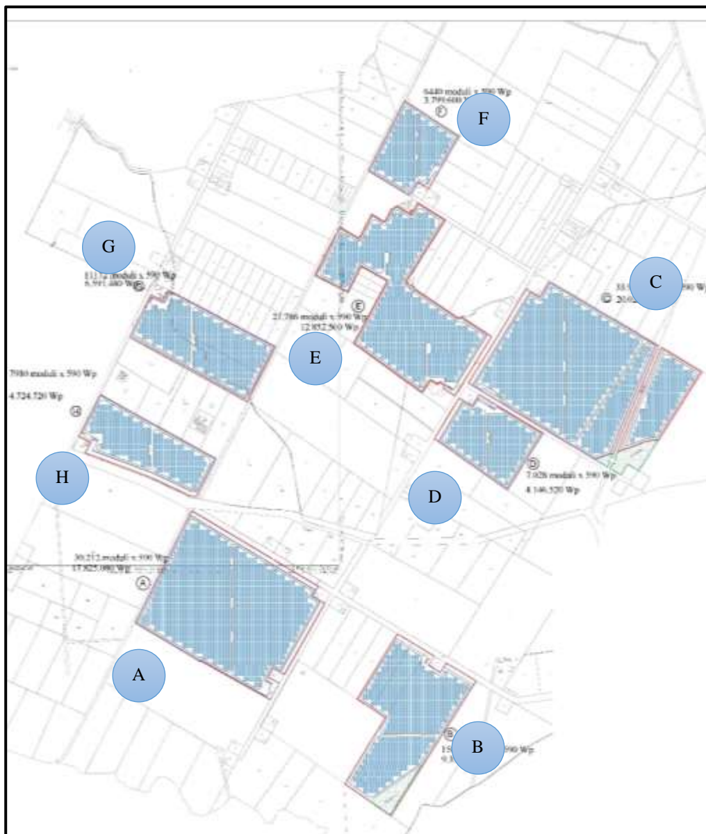
Figura 1: Layout Impianto su base catastale
