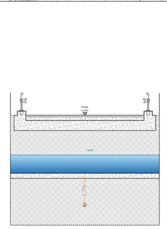
SEZIONE LONGITUDINALE PARTICOLARE TECNOLOGICO ATTRAVERSAMENTO TIPO CANALE DI SCOLO LUNGO LA VIA A. DIAZ
