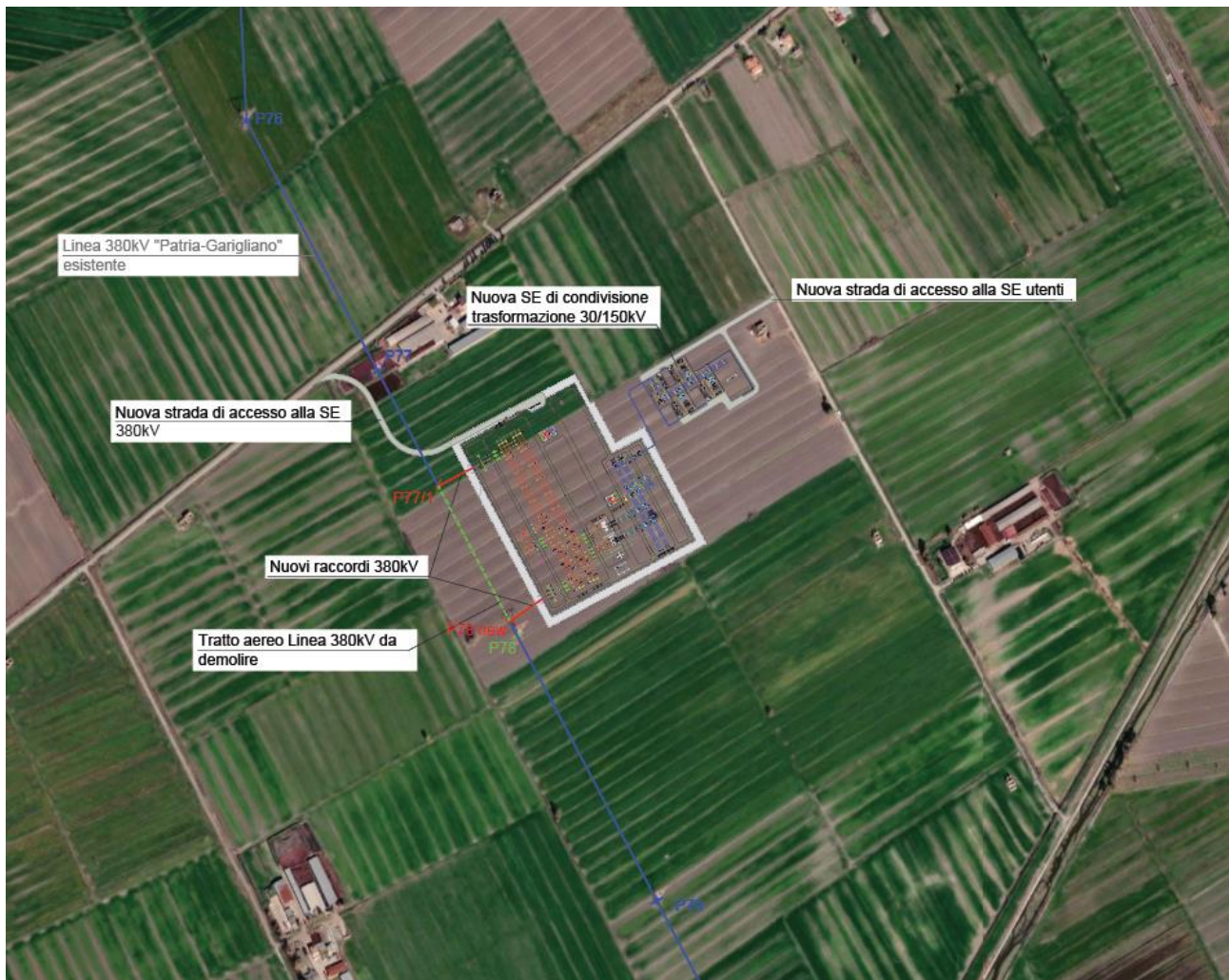
Figure 1: Ortofoto della nuova SE RTN 380/150 kV (a sinistra) e SE di condivisione/trasformazione 30/150 kV
