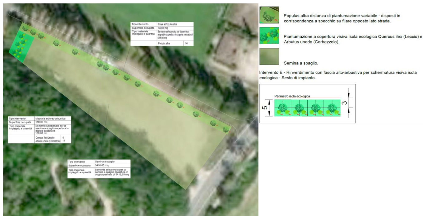
Figura 9-3 Misura di Compensazione - Ripristino con miglioramento dell'area di cantiere
