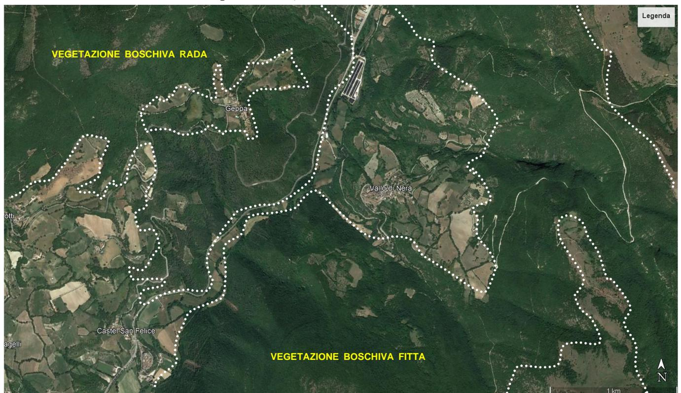
L'azione *regimante* è la capacità del bosco di ridurre il ruscellamento e quindi le portate massime di piena nei corsi d'acqua; esso difatti intercetta le precipitazioni con l'apparato foliare e rallenta la velocità delle gocce d'acqua.
