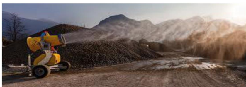
Impianto di nebulizzazione
