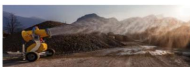
Impianto di nebulizzazione
