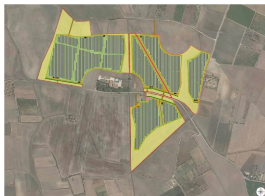
Figura 2 – Layout di impianto - In giallo l'area interessata dall'impianto, in verde le aree su cui sono montati i pannelli
