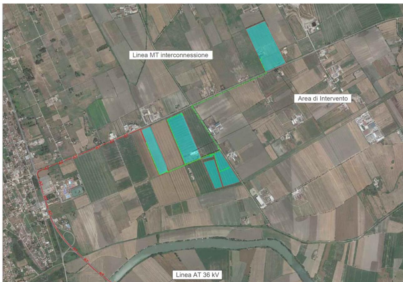
*Ortofoto con indicazione del Parco Fotovoltaico e del cavidotto di connessione alla futura Stazione Elettrica (SE) Terna della RTN a 380/150/36 kV da collegare in entra-esce alla linea RTN 380 kV "Garigliano-ST Patria"*
