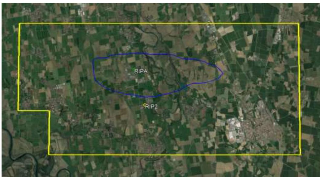
**Fig. 4. Ubicazione delle stazioni di monitoraggio GPS in continuo: in verde la stazione attiva (RIPA) ed in giallo la stazione di recente installazione (RIP2). La linea gialla rappresenta l'area della Concessione di Ripalta, la linea blu rappresenta la proiezione in superficie del limite del giacimento.**
