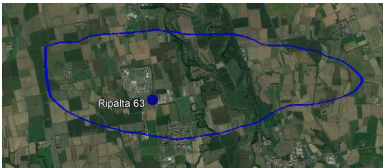
**Fig. 6. Ubicazione in mappa del pozzo di monitoraggio Ripalta 63, entro cui è alloggiata la strumentazione microsismica di pozzo profondo. La linea blu rappresenta la proiezione in superficie del limite del giacimento.**
