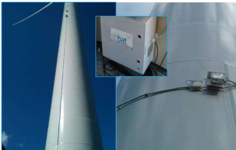
Figura 7.3: Sensori del sistema DTBat® prodotti dalla società Liquen Consultoria Ambientale S.l.
