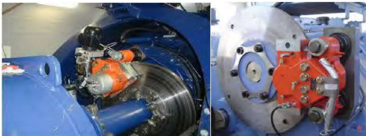
Figura 7.4: Sistemi di freno a disco sull'asse-rotore. Il sistema di controllo DTBird/Bat® invia un segnale di frenata del rotore che fa variare il passo delle pale, le pinze bloccano il movimento residuo della rotazione
