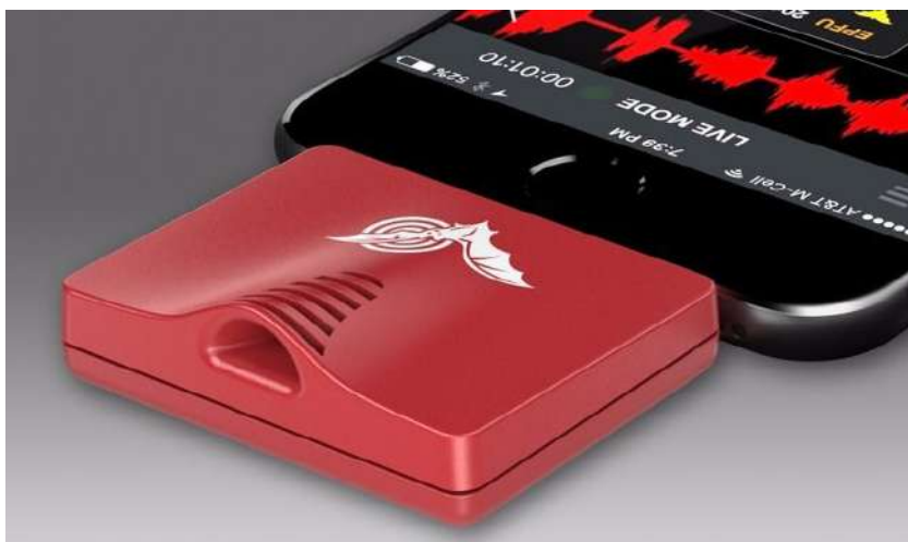
Figura 2.7: Rilevatore di pipistrelli Wildlife Acoustics Echometer Touch 2 collegato a un dispositivo mobile.
