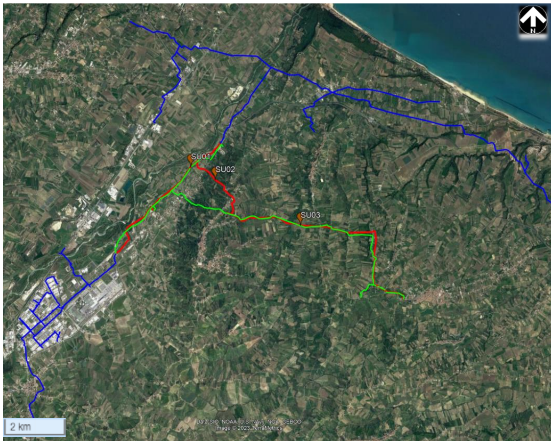
Figura 5-5 – Punti di monitoraggio della componente suolo e sottosuolo. In rosso i tracciati in progetto, in verde quelli in dismissione e in blu quelli in esercizio.
