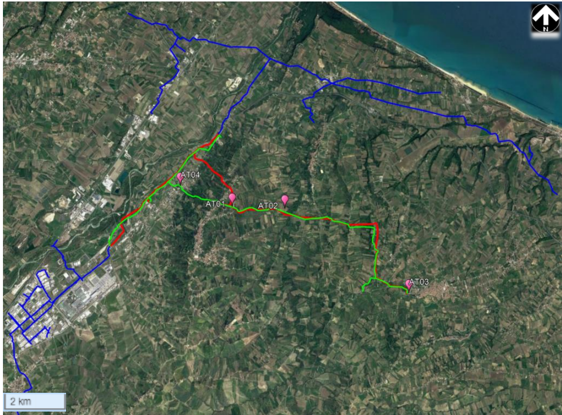
Figura 5-9 – Stazioni monitoraggio della componente “Aria e Polveri”. In rosso i tracciati in progetto, in verde quelli in dismissione e in blu quelli in esercizio.
