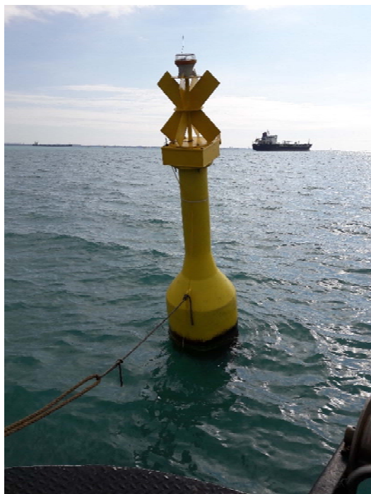
Figure 6 e 7 – boa di monitoraggio della torbidità e sensore della torbidità
