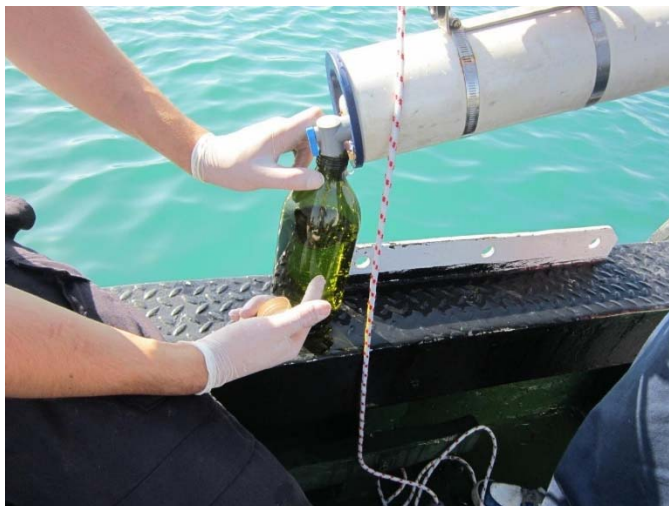
Figura 4 – campionamento con bottiglia Niskin per il prelievo campioni d'acqua
