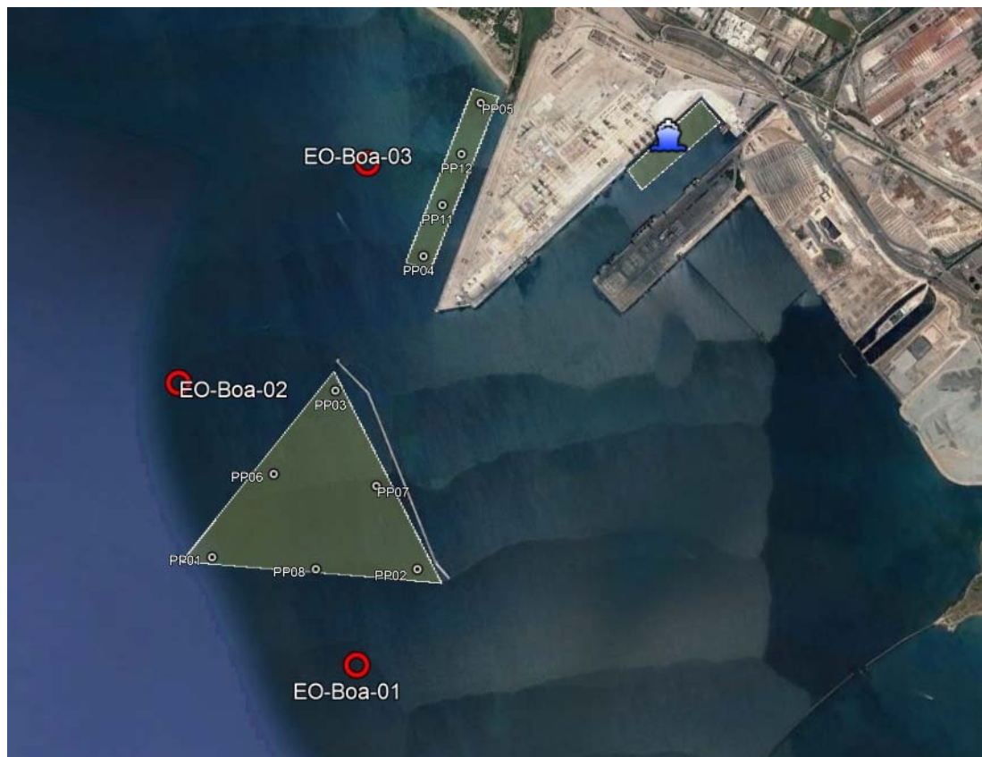
Figura 3 – punti di monitoraggio della torbidità in continuo
