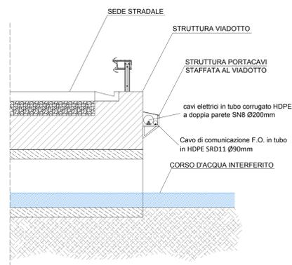
TIPOLOGICO ATTRAVERSAMENTO CORSO D'ACQUA MEDIANTE SEZIONE DI POSA RIDOTTA CON BAULETTO IN CLS
