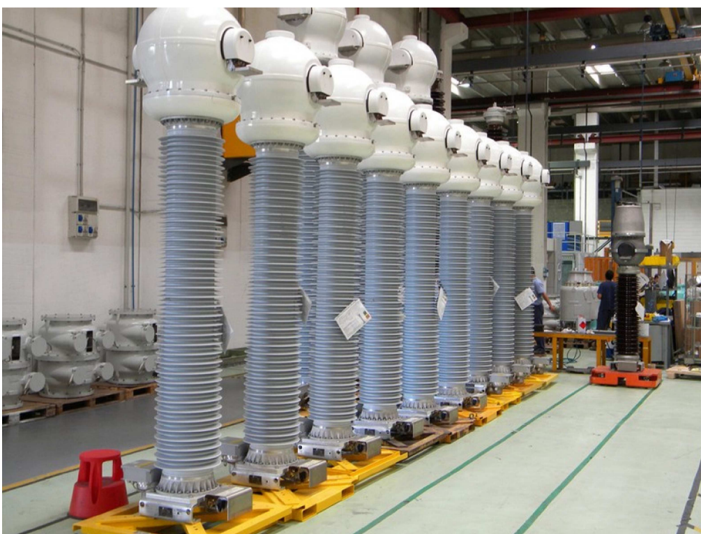
5 TRASFORMATORE DI CORRENTE TA
