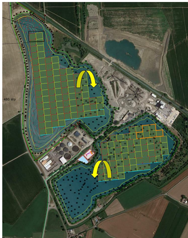
Figura 13. Flusso delle acque di pioggia dai pannelli al bacino di cava (freccie gialle).
