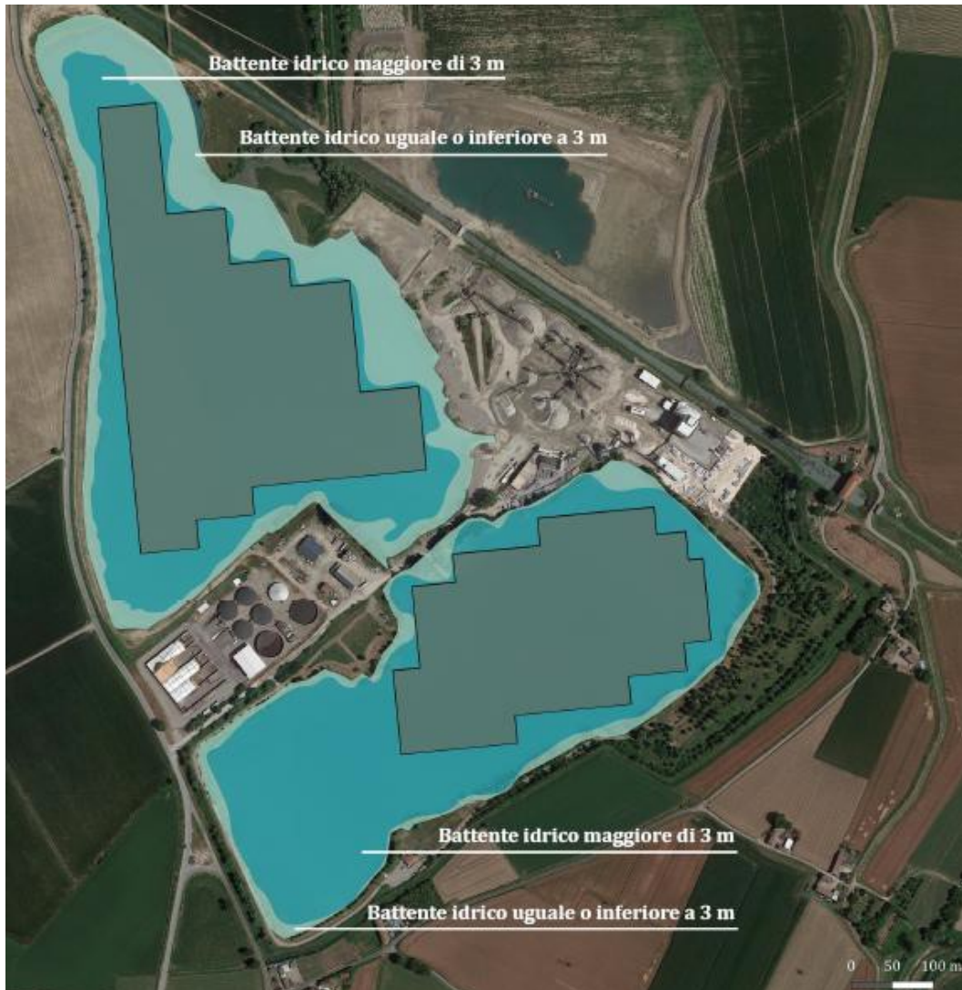
Figura 34. Batimetrie lacuali ed occupazione dei moduli fotovoltaici
