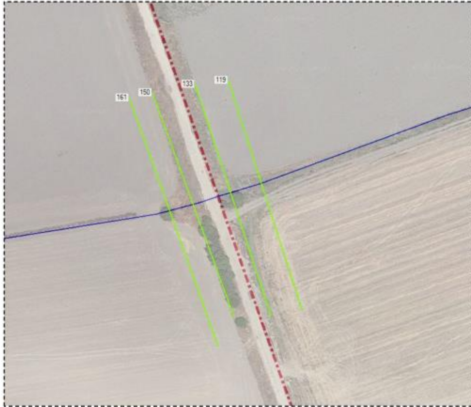
Figura 49 Ortofoto interferenza cavidotto con reticolo idrografico TOC_4
