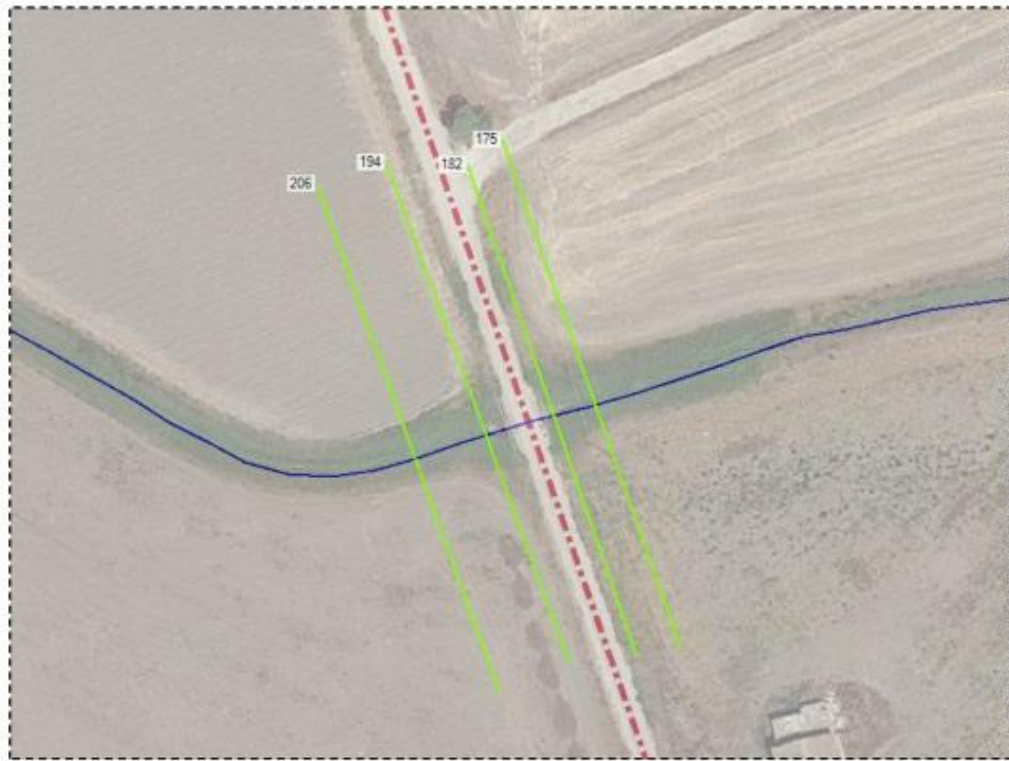
Figura 47 Ortofoto interferenza cavidotto con reticolo idrografico TOC_3
