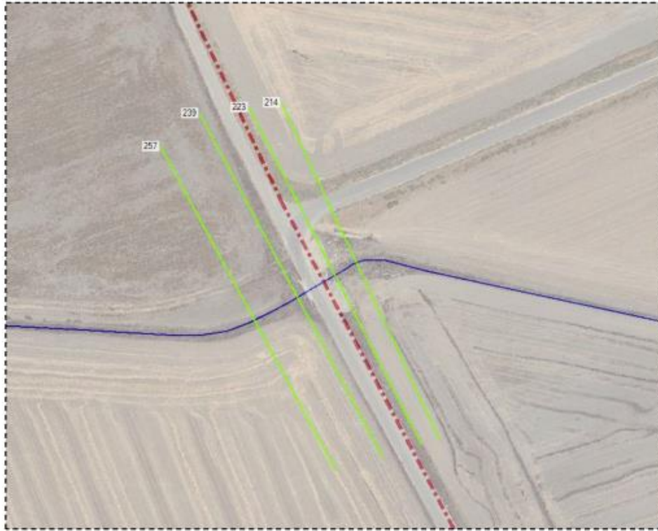
Figura 45 Ortofoto interferenza cavidotto con reticolo idrografico TOC_2
