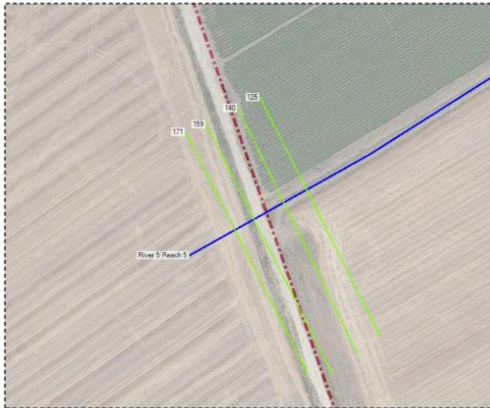
Figura 51 Ortofoto interferenza cavidotto con reticolo idrografico TOC_5
