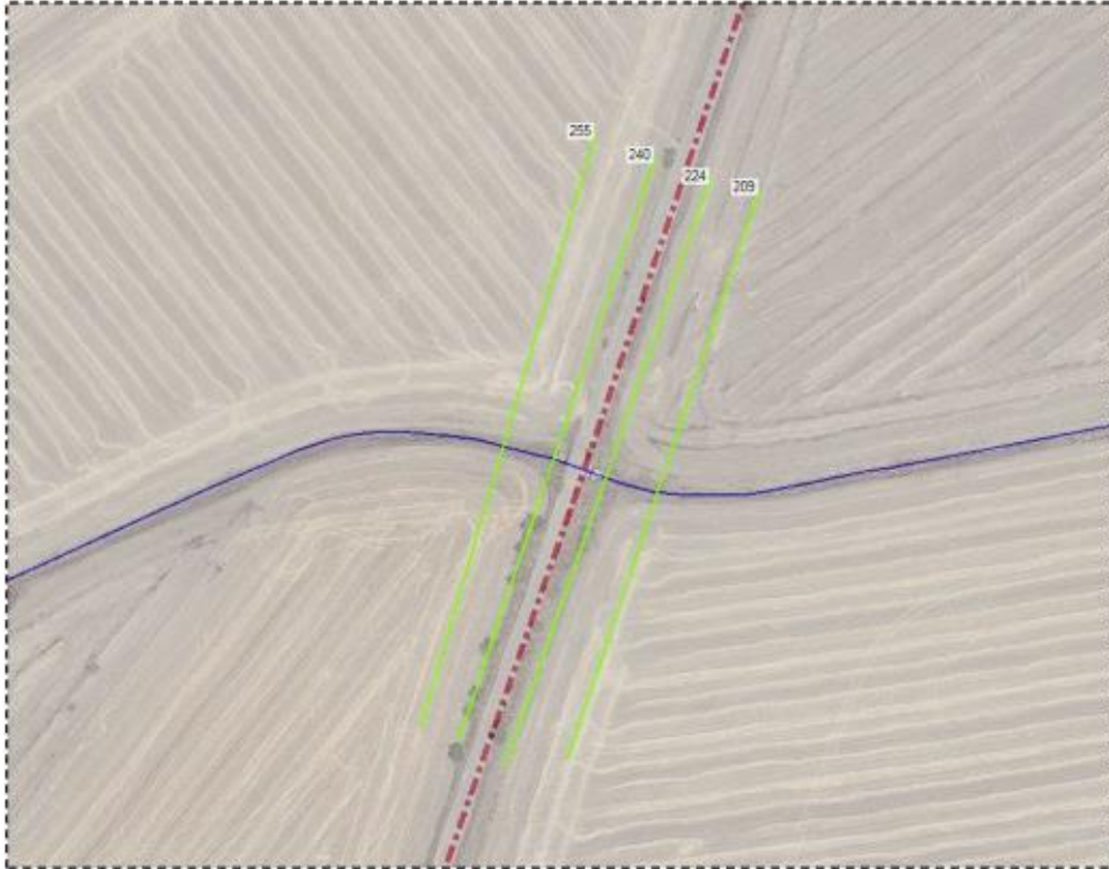
Figura 43 Ortofoto interferenza cavidotto con reticolo idrografico TOC_1
