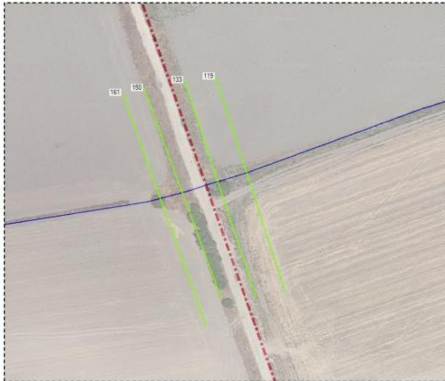
Figura 48 Ortofoto interferenza cavidotto con reticolo idrografico TOC\_4
