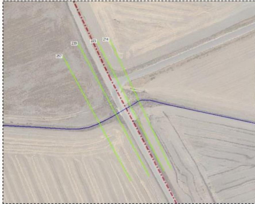
Figura 44 Ortofoto interferenza cavidotto con reticolo idrografico TOC\_2
