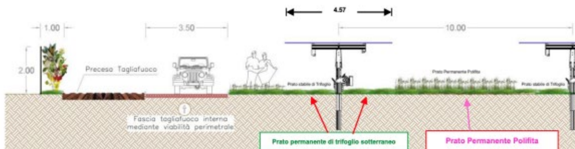
Figura 3. Sezione dell'impianto con l'indicazione della disposizione delle colture agrarie, della recinzione perimetrale e della fascia tagliafuoco interna (SIA).
