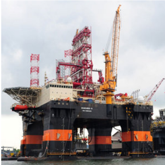
Figura 3-10: impianto di perforazione semisommersibile SCARABEO 9 (vista diurna)
