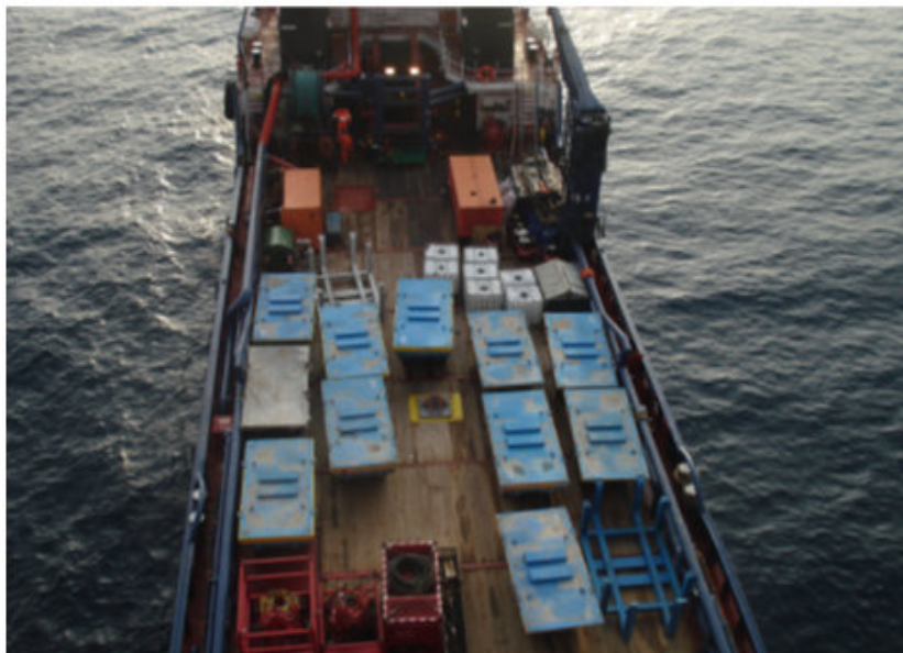
Figura 3-28: trasporto a terra dei cassonetti tramite Supply Vessel
