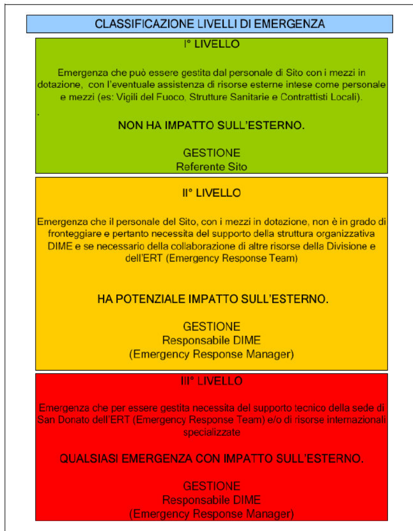
Figura 3-5: schema di classificazione del livello di emergenza (Fonte: doc. eni "Programma geologico e di perforazione Pozzo Lince 1, marzo 2014)
