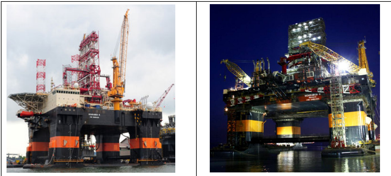
Figura 3-3: impianto di perforazione semisommersibile SCARABEO 9 (vista diurna e notturna)
