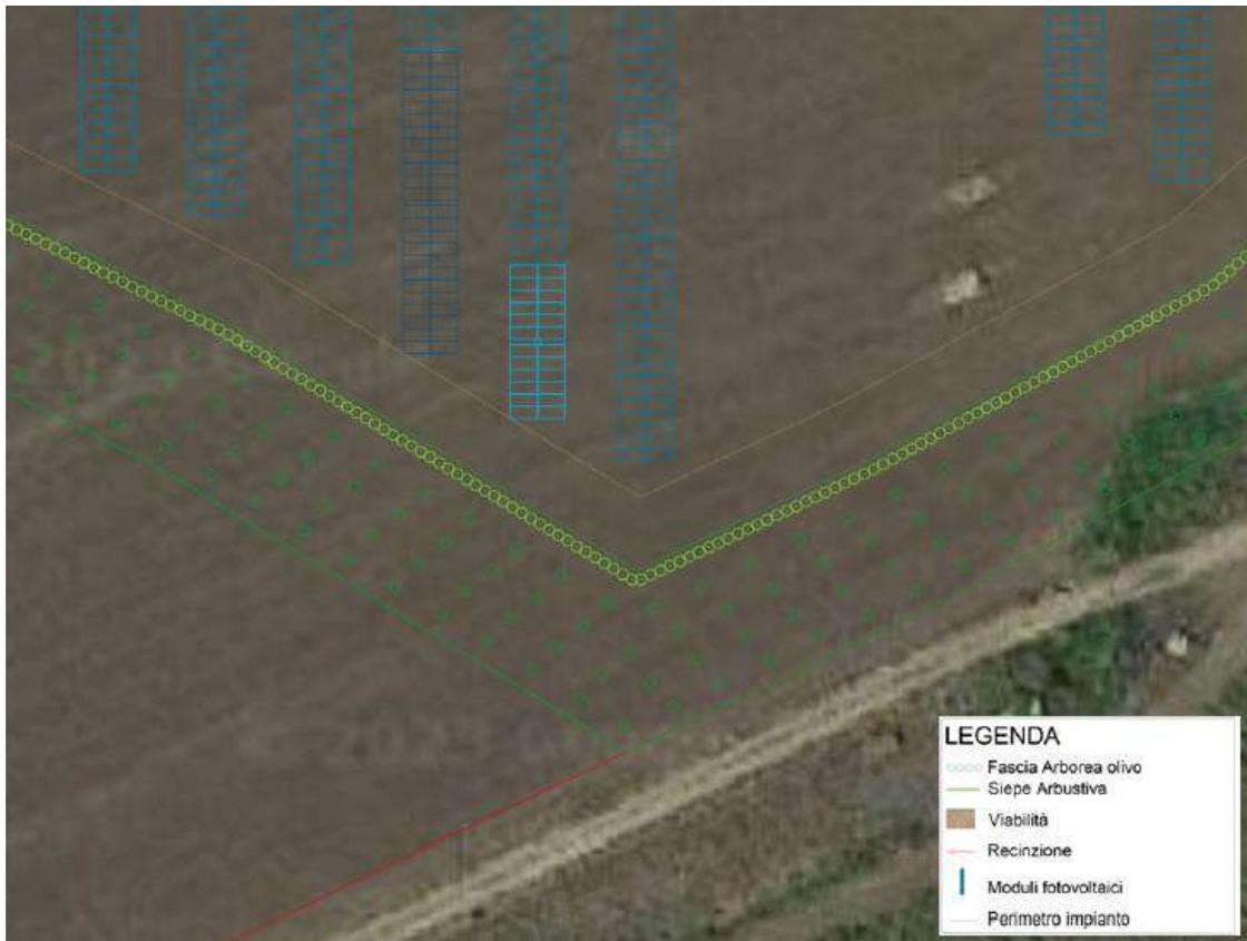
*Figura 10.5a. – Impianto Agrivoltaico: Dettaglio Fascia arborea e Siepe.*
