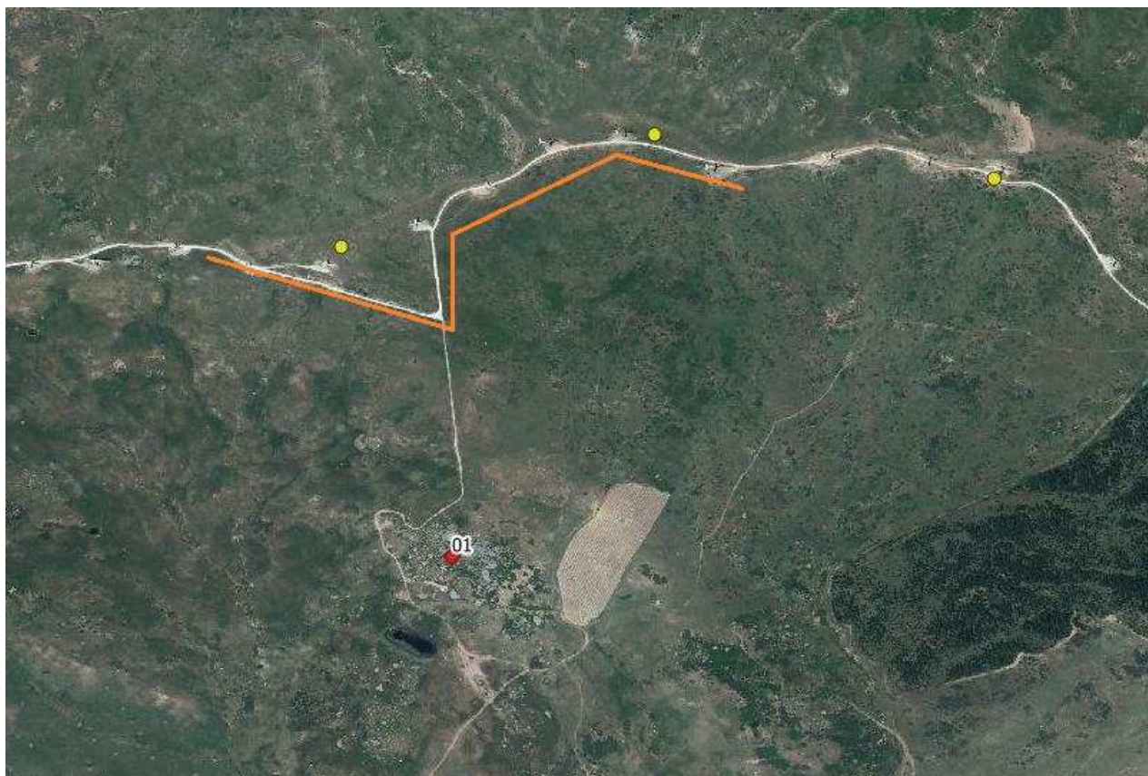
Figura 18. Ipotesi di posizionamento barriere fonoassorbenti nel corso delle attività di cantiere, al fine di ridurre l'inquinamento acustico nei confronti del sito di nidificazione del Lanario (in rosso).
