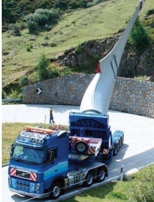
Figura 3-2: Esempio di blade lifter
