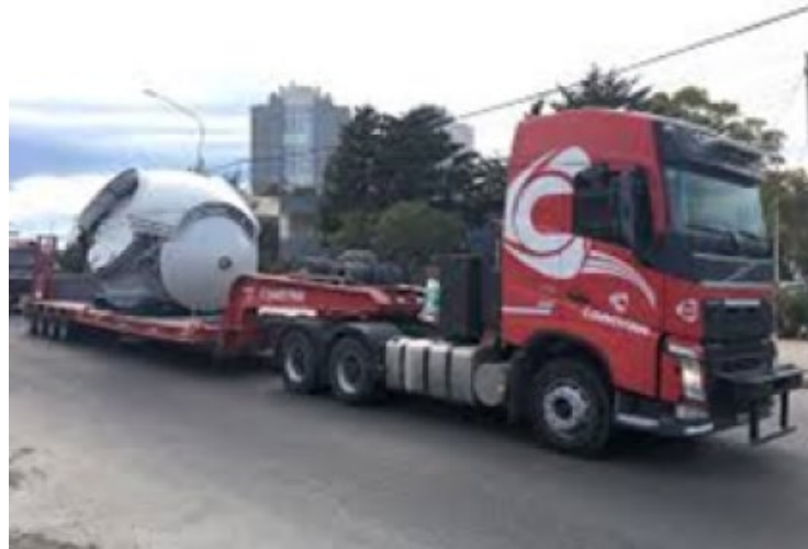
Figura 3-4: Esempio di trasporto del mozzo
