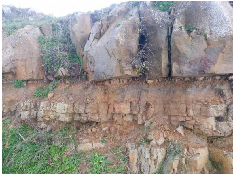
Figura 3-1: Dalla foto visibili i livelli litoidi alternati a livelli argillosi
