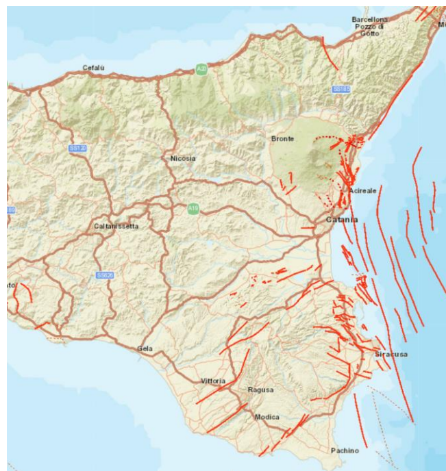
Figura 8-1: Progetto ITHACA (ITaly HAZards from CAPable faults) - Catalogo delle faglie attive e capaci (FAC)
