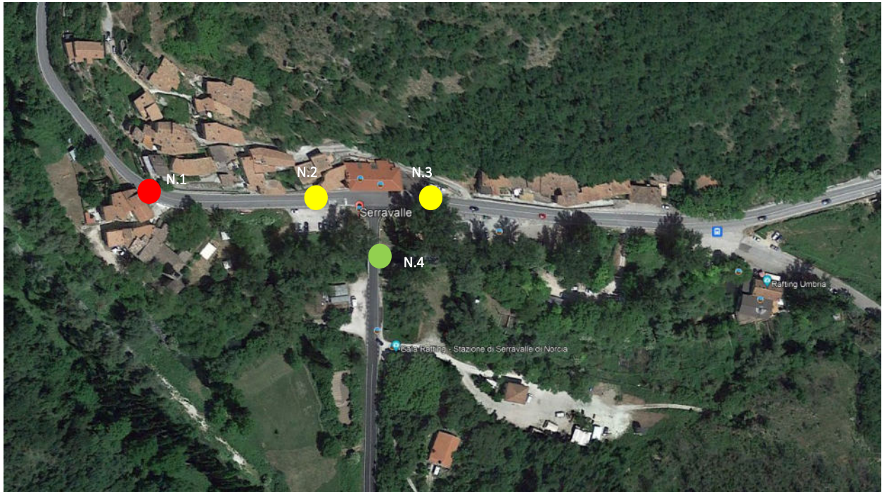
Figura 2-1 – Stato Attuale – elementi di criticità: 1 strettoia all'ingresso dell'abitato, 2-3 segnali di stop, 4 ponte esistente.
