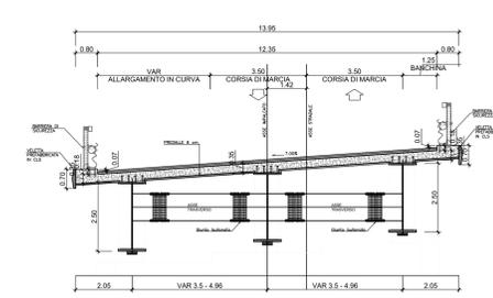
SEZIONE TIPO PONTE AD ARCO A VIA INFERIORE
