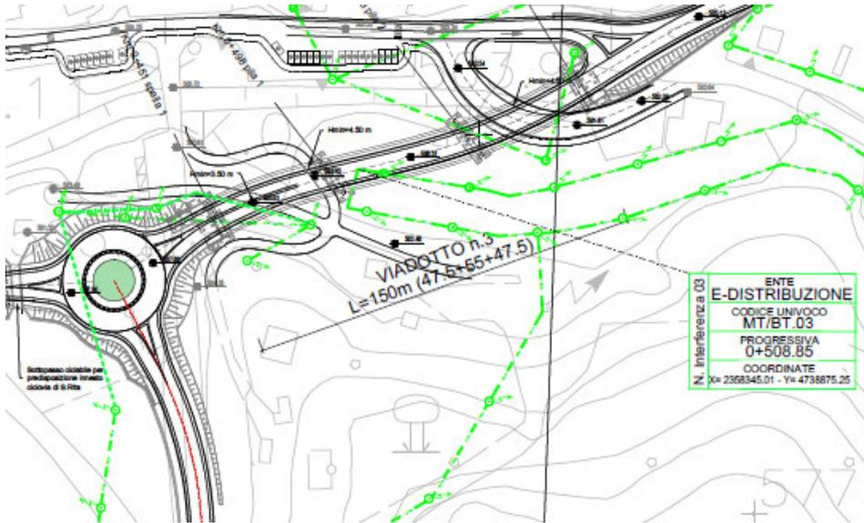
Fig. 4.a – Interferenza 03 rete elettrica aerea MT/BT.03
