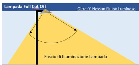
Figura 8.2 Esempio di illuminazione con apparecchiatura "Full Cut Off"
