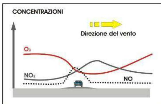
Figura 5 Andamento qualitativo della concentrazione di NO, NO2 e O3 nella sezione di una strada
