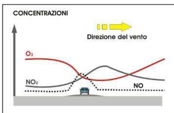
Figura 5 Andamento qualitativo della concentrazione di NO, NO<sub>2</sub> e O<sub>3</sub> nella sezione di una strada
