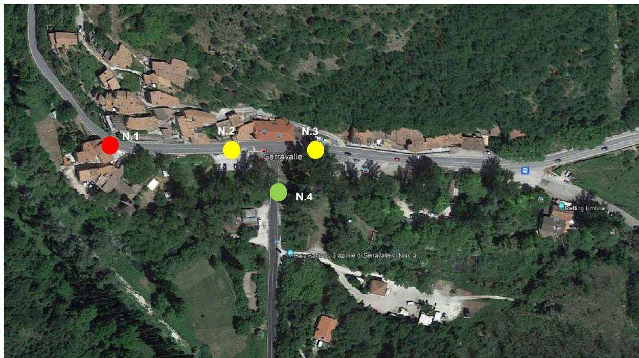
*Figura 1 Stato Attuale – elementi di criticità: 1 strettoia all'ingresso dell'abitato, 2-3 segnali di stop, 4 ponte esistente*
