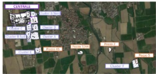
Figura 9 Configurazione di progetto pozzi (in viola le nuove aree Cluster, in arancione i pozzi esistenti che resteranno in esercizio)
