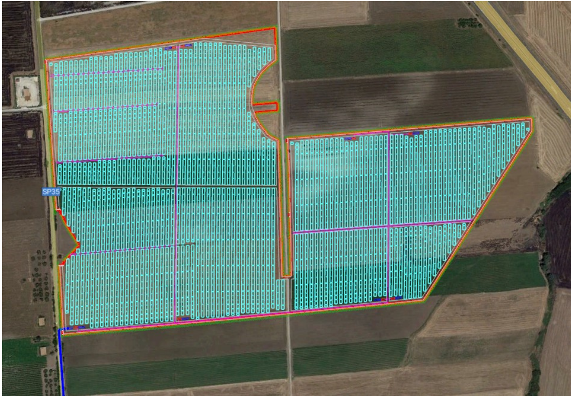
Inquadramento su orto foto dell'impianto fotovoltaico
