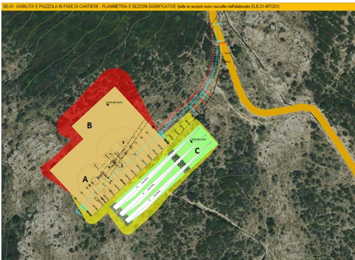
Fig. 9: SE - 01 Configurazione in fase di cantiere: aree aerogeneratore SE – 01 Vista dall'alto con aree A, B, C e gru da 200t
