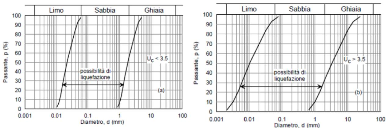
Nel caso in esame sussistono almeno 3 delle condizioni (granulometria, profondità della falda e accelerazioni massime attese) per non avere terreni soggetti a liquefazione.
