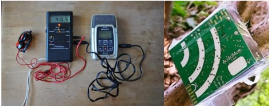
Figura 3-2: Strumentazione per i rilievi ultrasonori: a sinistra bat detector manuale D240 X Pettersson Elektronik e registratore digitale Zoom H2; a destra Audiomoth 1.2.0
