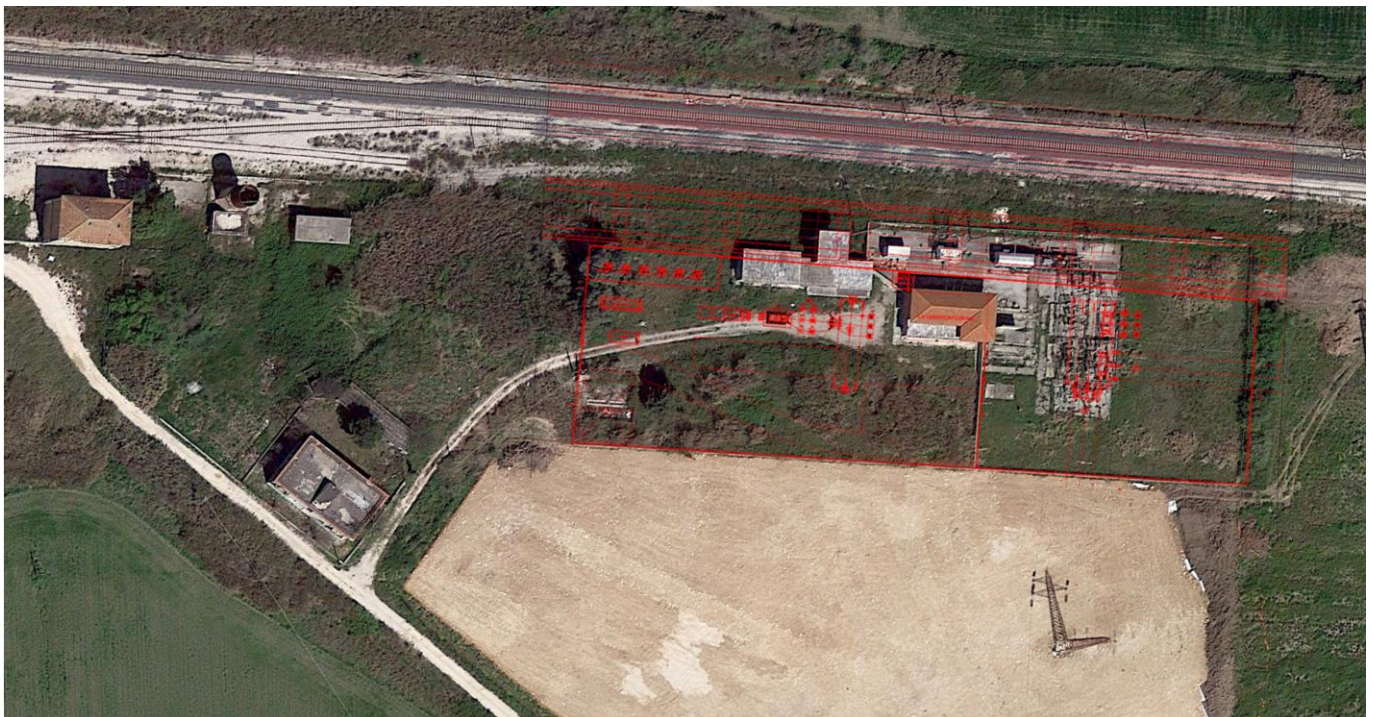
Figura 6: Sovrapposizione Planimetria di Progetto SSE Temporanea (in rosso) – Fotoaerea stato di fatto
