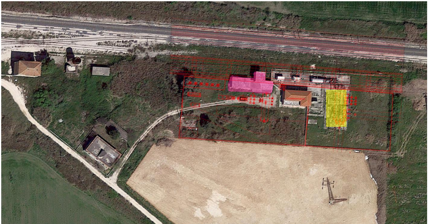
Figura 7: Sovrapposizione Planimetria di Progetto SSE Temporanea (in rosso), nel riquadro giallo l'attuale SSE che verrà adeguata e nel riquadro rosa il fabbricato da demolire– Fotoaerea stato di fatto
