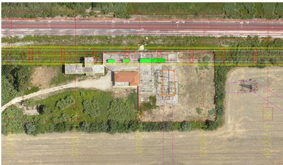
Figura 1: Sovrapposizione SSE Ripalta con plinti viadotto Ripalta
