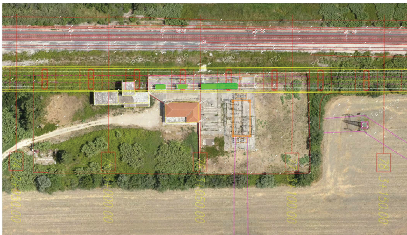
Figura 1: Sovrapposizione SSE Ripalta con plinti viadotto Ripalta
