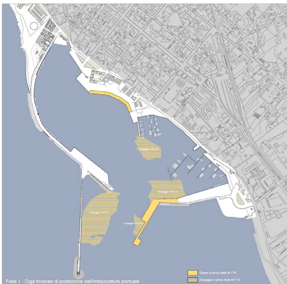
Figura 49 – FASE I – Opera foranea, dragaggi e completamento banchina curvilinea
