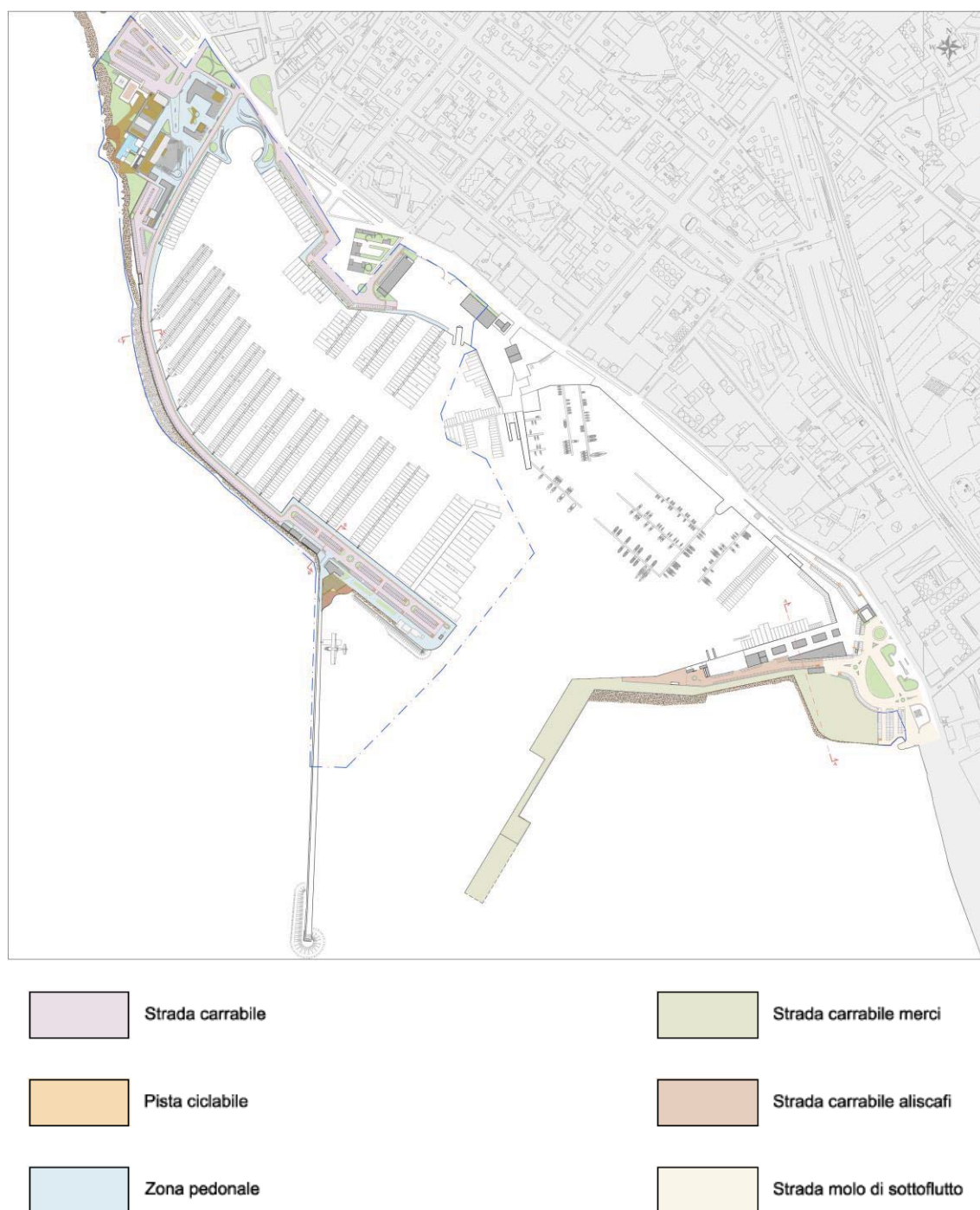
Figura 28 – Viabilità interna al Porto
