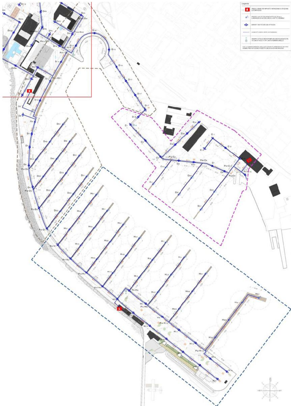
Impianto antincendio – Schema generale
